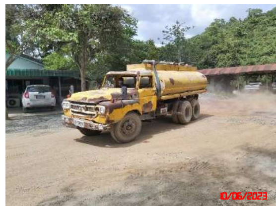
รูปที่ 8 การฉีดพรมน้ำบริเวณพื้นที่โครงการ
